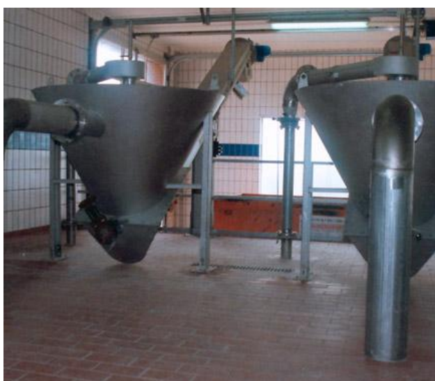
Примеры установки для сепарации и обезвоживания песка HUBER COANDA RoSF 3
