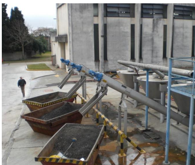
Примеры установки для сепарации и обезвоживания песка HUBER COANDA RoSF 3
