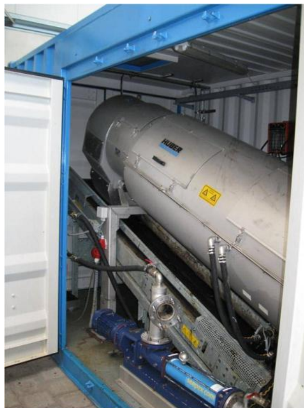
Пример мобильного исполнения пресса RoS 3 в 20-футовом контейнере
