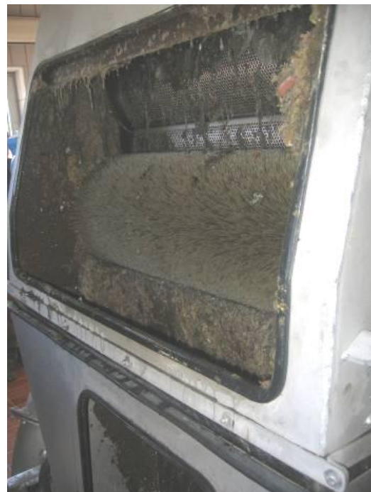
Очистка перфорированных пластин с помощью валика-щётки
