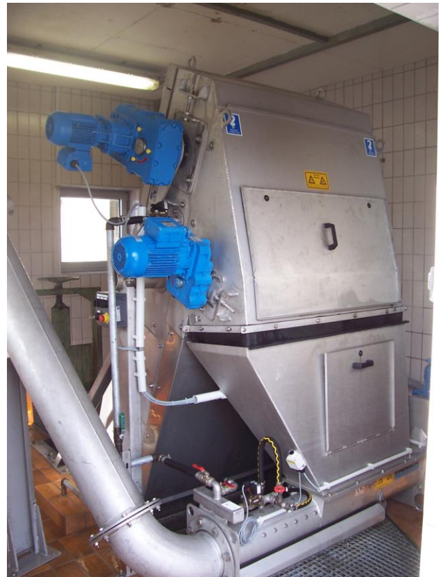
Решетка HUBER EscaMax® с подключенным моечным прессом для отходов HUBER WAP SL
