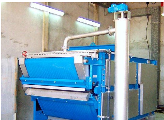
HUBER BS – ленточный фильтр-пресс для обезвоживания осадка
